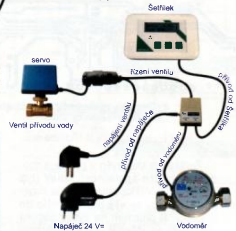
Regulace a měření spotřebované vody. Propojení vodoměru, napájecího zdroje, ventilu pro vodu (se servem) a Šetřilka pomocí konektorů (bez použití nářadí).
