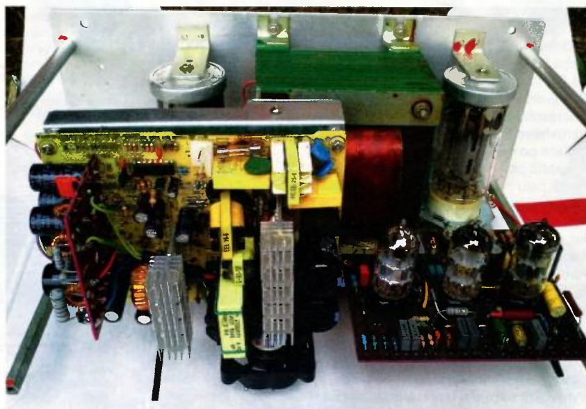
Obr. 32. Napájecí zdroj v zesilovači
