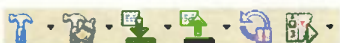
Obr. 12. Tlačítka pro sestavení projektu dostupná z hlavní nástrojové lišty prostředí MPLAB X
