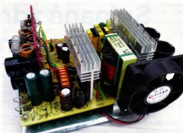
Obr. 31. Hotový zdroj s pomocnou deskou a ventilátorem
